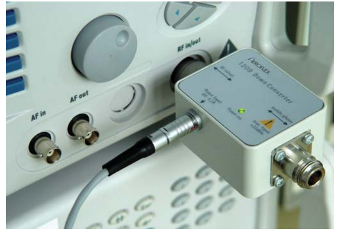
Figura 2: El 1209 Downconverter es una extensión de frecuencia opcional para realizar pruebas Bluetooth, WLAN, GPS y para los estándares de TV móvil.
